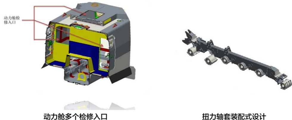
车辆采用东风康明斯工业电喷发动机，带涡轮增压，高原适应性强，采用全程调速，扭矩需求响应快。发动机只需按常规车辆要求正常维护和保养即可实现长寿命使用，无需参照常规装甲车辆规划摩托化小时。车辆发动机舱设计有顶部和司机室内部检修入口，方便维修。传动系统采用特种独立四驱机械传动系统，可靠性强，维护保养间隔周期长。底盘扭力轴套采用模块装配式设计，可快速更换维修。
