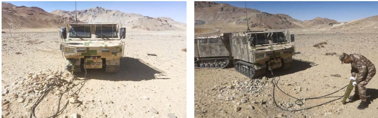
该车前车设计工程应用控制模块，加装液压动力快速连接平台，实现多种单兵液压工具的快速连接和切换使用，满足单兵高原高寒冻土条件下简易工事构筑需要。整车可加挂3吨挂车，依任务需求，装载各类工程施工机具，满足高原战场作战工事构筑需求。
