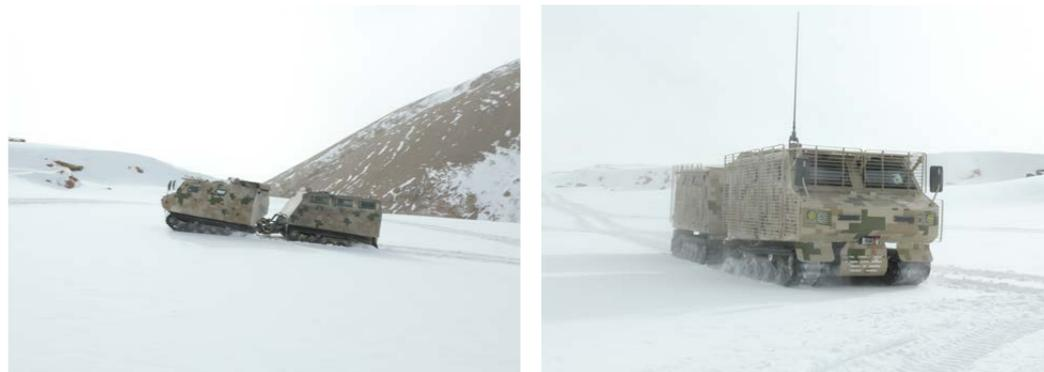
该车可在高原、荒漠、雪地、沼泽、滩涂、内河水域等复杂战场环境下快速部署，机动作战；亦可作为反恐维稳、应急抢险、极地科考的保障装备，在恶劣地形和气候条件下完成作战、通讯、运输、医疗、消防等特种作业。通过实地验证，该车可完成6000米海拔下重点点位、阵地全天候气象条件下的应急支援、兵力和物资快速投送任务。
