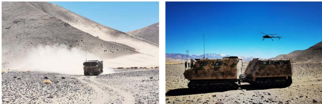
该车可利用其在高原高寒极端气候条件下特殊复杂地形、路段的超强机动特性，实现对边境地区重点目标、路段快速占领、卡口制要和兵力投送。采用承载式装甲防弹车体设计，车身外挂格栅装甲，可防火箭弹攻击；车身装甲厚度4.2mm，可防7.62mm普通弹。车内安装的供氧、供暖、供电、净水装置设施可满足班组人员（14人）长期（30天以上）驻防及作战需求。根据作战需求，可随车搭配多型武器装备，实现对中印边境敏感地区及对峙点位长期警戒和驻守。
